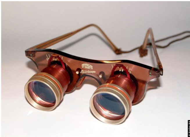
Рис.5. Цейссовский театральный бинокль, оформленный в виде очков, – прямой потомок телескопа Галилея.
